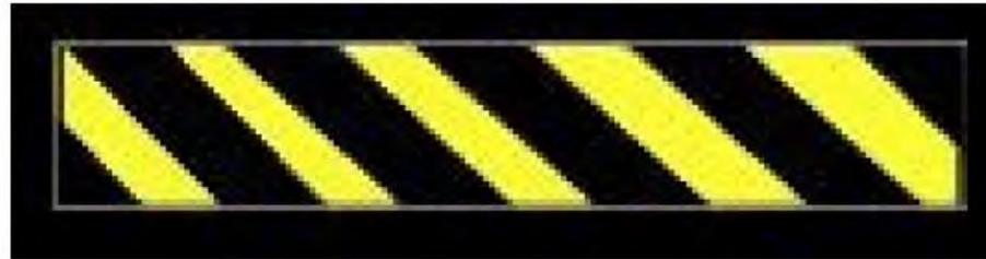
**Per la segnalazione di ostacoli come fosse, gradini, pilastri lungo una via di passaggio, bozzelli di gru, oggetti di macchine sporgenti, ecc., si usano bande giallo/nere a 45°**
