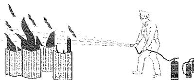
Olio e benzina accesi, situati in contenitori aperti, non vanno mai spenti usando l'estintore dall'alto, ma orientando il getto dell'estintore sul bordo del contenitore, cercando di rompere la fiamma per permettere il soffocamento dell'incendio.
