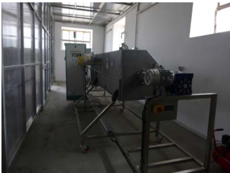
Apparecchiatura a microonde: vista dal lato dello scarico dei materiali irradiati.
